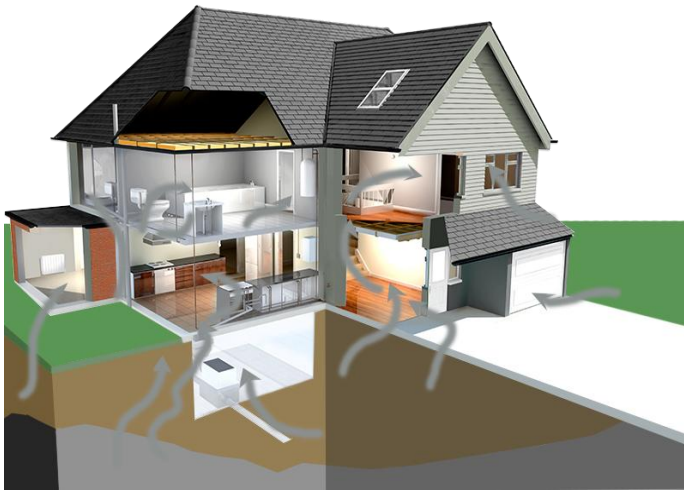
Fig. 2 - Vías de entrada do radon. Fonte: Infografía do autor.
